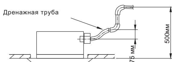
При необходимости соединения нескольких дренажных труб, соединяйте их согласно, ниже приведённой, схемы.
